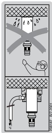
При сверлении потолочного перекрытия обязательным является использование системы водоотвода в комбинации с промышленным пылесосом.
